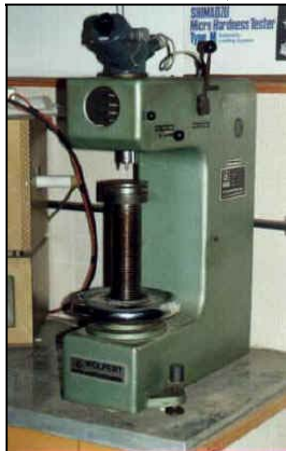
Durómetro Vickers ((Laboratorio de la E. E. T. N° 466 - Rosario -Santa Fe)
