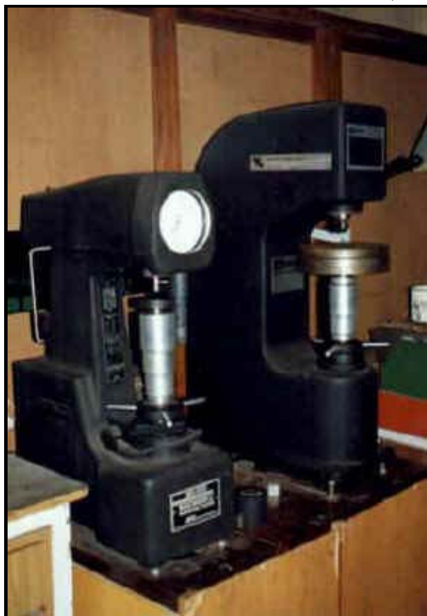
Durómetro Brinell y Rockwell (Laboratorio de la E. E. T. N° 466 - Rosario -Santa Fe)
